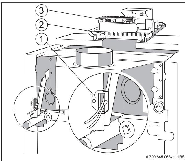
Рис. 23 Подключение электрических проводов
