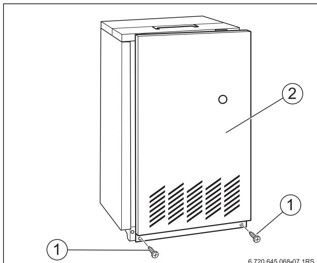
Рис. 40 Установка передней стенки котла
