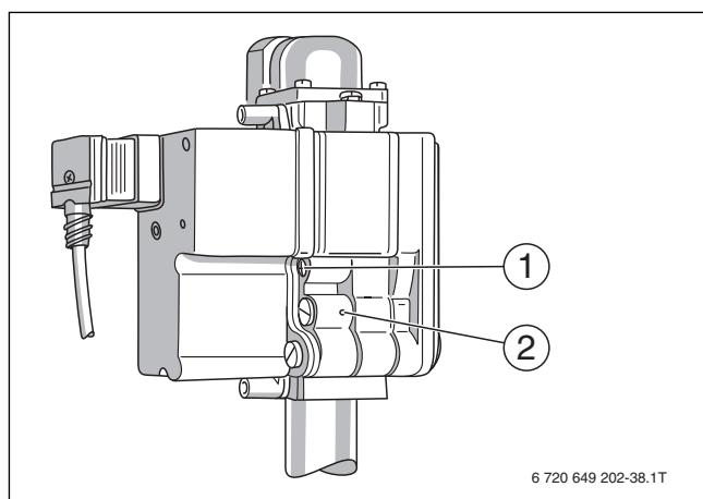
Рис. 56 Газовая арматура "ВМ" 762-012
