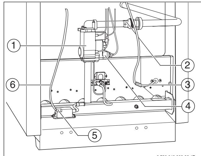
Рис. 47 Демонтаж горелки
