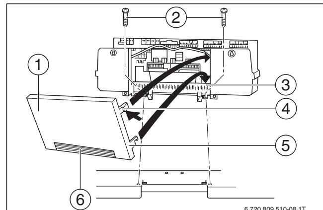
Рис. 22 Крепление Logamatic 4000
