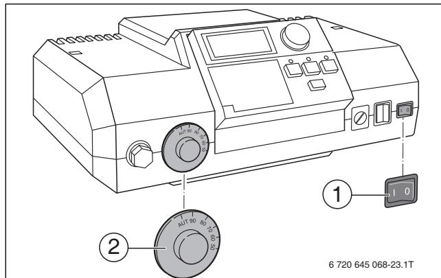
Рис. 31 Включение отопительной установки на системе управления (Logamatic 2000)
