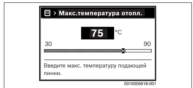
Рис. 25 Установка максимальной температуры подающей линии
