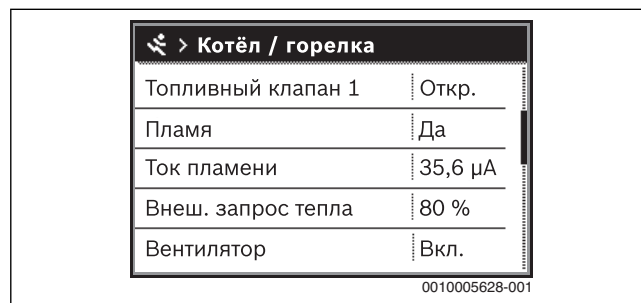
Рис. 32 Ток ионизации (пламени) в меню мониторинга
